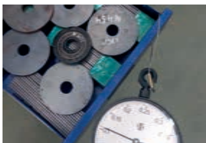
Деформация стенки ящика 3 мм, направляющие без изменений
