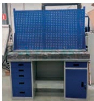
Нагрузка 800 кг, прогиб 0,5 мм
