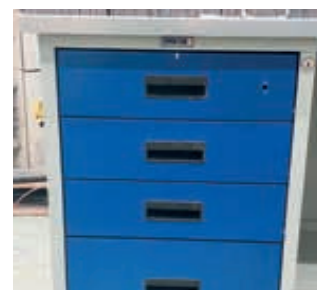
Закрытое состояние. Нагрузка на ящик 45 кг, работоспособность не нарушена.
