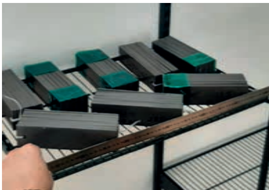
Нагрузка 40 кг. Прогиб 2,1 мм
