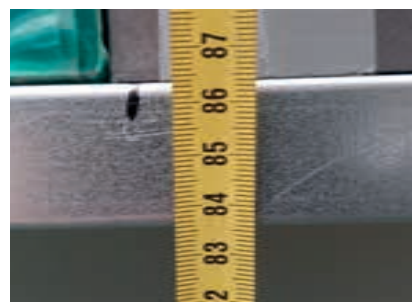
Нагрузка 450 кг- прогиб 5.0 мм
