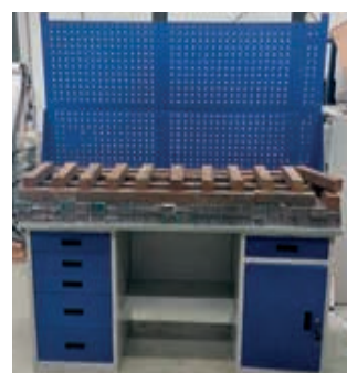
Нагрузка 1300 кг, прогиб 0,5 мм
