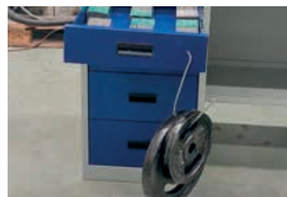
Вертикальная нагрузка 30 кг + 15 кг
