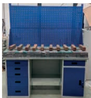
Нагрузка 800 кг, прогиб 0,5 мм
