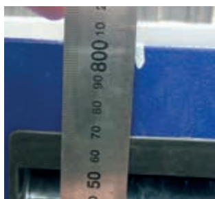
Открытое состояние. Нагрузка 35 кг, провисание порядка 5 мм (норма 12 мм).
