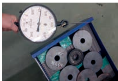
Нагрузка 37,5 кг, Горизонтальная нагрузка 100 Н
