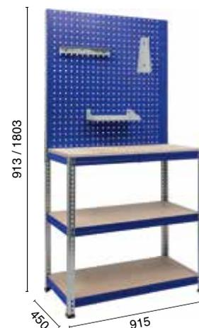
Столешница – фанера 21 мм, покрытая лаком. Опоры из стойки стеллажа SBL с подпятниками, с геометрическим профилем 36x36 мм, 2 экрана. 2 полки, с настилом ХДФ. (1 место)
